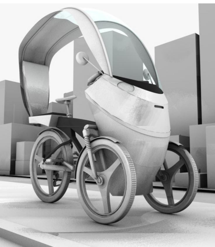
**CarCityBike** è un mezzo di locomozione a pedali con due ruote anteriori, tra le quali è situato un bauletto per il trasporto di carichi leggeri, e una posteriore.
